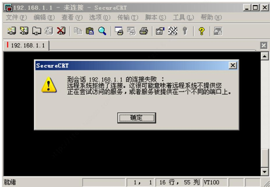
8、配置 SSH 的连接，同时还需要注意 Cisco 路由器不支持 SSH1 的 zlib 的压缩，而 secureCRT 默认是启了此压缩，因此需要编辑属性修改压缩属性：
