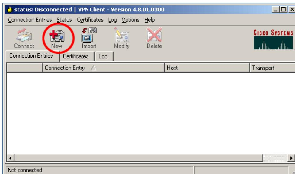
21、建立新的连接图示，并且填写 VPN SERVER 的主机地址和相应的客户组的组名和认证密码：
