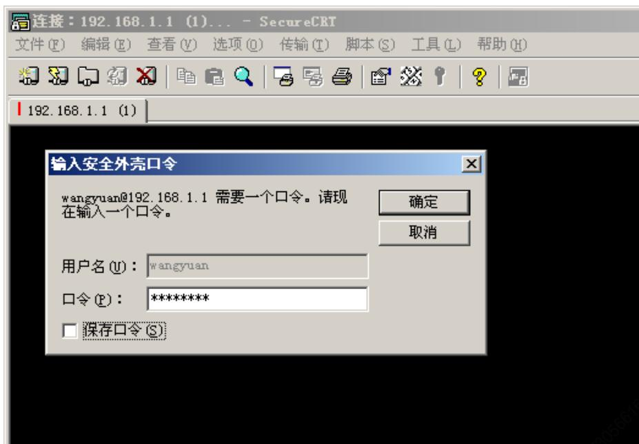
11、在输入正确的密码后，即可以登录到 R1 路由器了，如下图所示：
