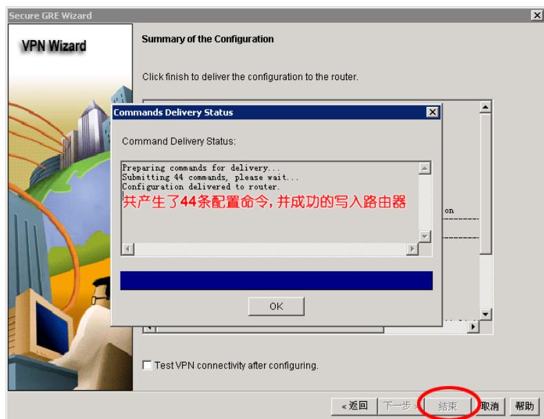
16、点击 OK 按键，结束对 R1 的配置，采用相同的配置方法，对 R3 进行配置，需要注意的是在配置 R3 路由器的 OSPF 配置时，需要为 R3 路由器的私有内部网络选择不同的区域号，以避免产生区域被分隔的问题，如下图所示：
