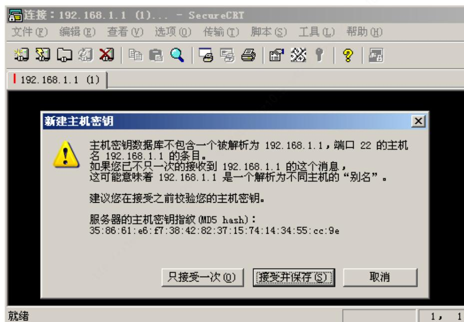
10、接受密钥后，本地 secureCRT 会弹出要求提供密码的对话框：
