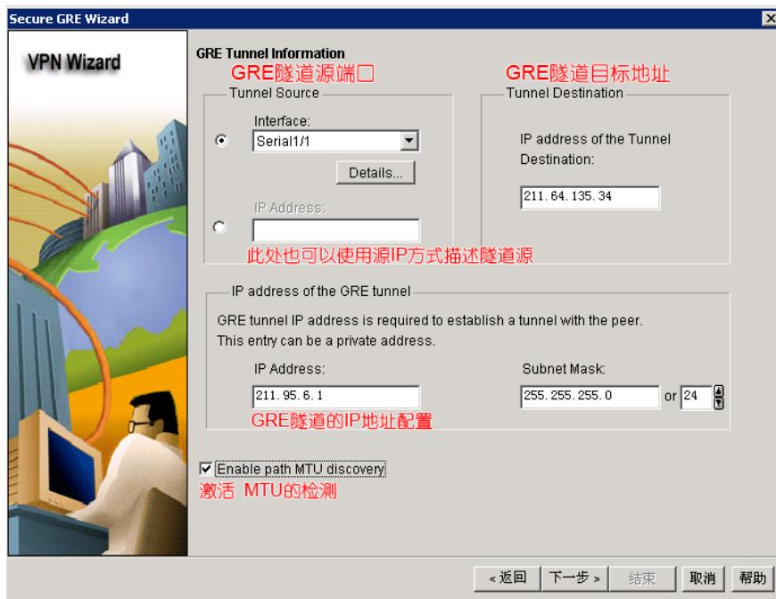
8、配置 GRE 的备份隧道，由于本实验不包含备份隧道，因此，此处直接点击下一步，如下图：
