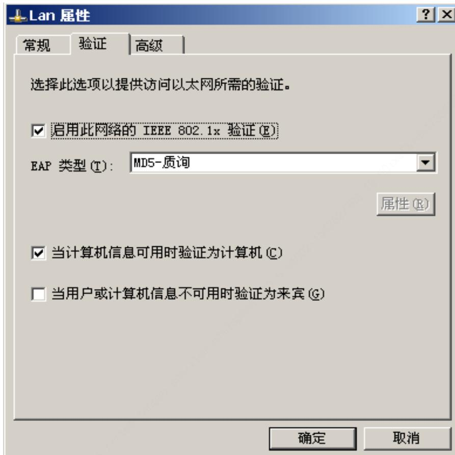
15、将 R1 和 R2 客户端的网卡连线到 3550 交换机的 FastEthernet 0/1 接口后。Windows 系统会弹出 802.1X 的认证登录对话框。在此输入 802.1x 的帐号和密码。
