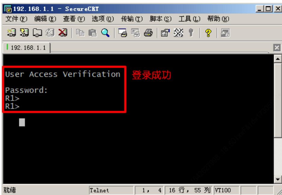
4、此时使用的 Telnet 的连接方式，如果在网络安装有 sniffer 软件，则之前的 Telnet 密码可能已经被截获。其主要原因是 telnet 发送的是明文密码。因此，有必要在路由器实施 SSH，SSH 连接使用了不对称密钥的密码来与客户端协商认证，并且产生加密密钥，用于会话加密，有效的保护了 telnet 会话。
