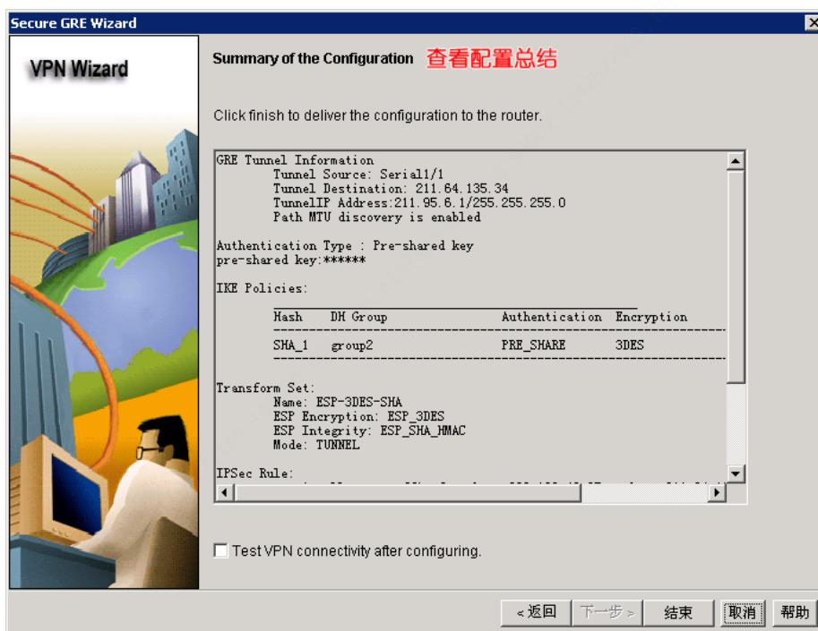
15、点击结束，SDM 将生成的配置，写入到 R1 路由器，如下图所示：
