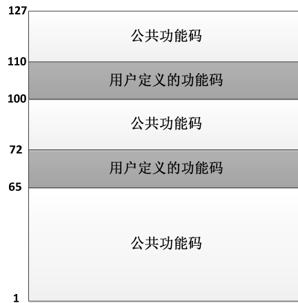
图 4.5 Modbus 功能码类型
