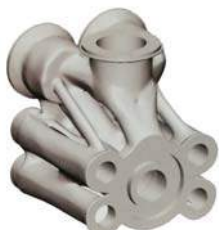
用 3-maticsSTL 软件使几何表面光滑以准备增材制造模型
