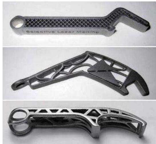
▲ 图 2 ReaLizer、Premium AEROTEC 和 Olaf Diegel 制造的开瓶器 (由上至下)
