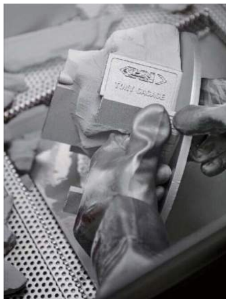
▲ 图3 利用 Arcam 的 EBM 设备打印出组件后，在保护气体环境中完成粉末去除过程
