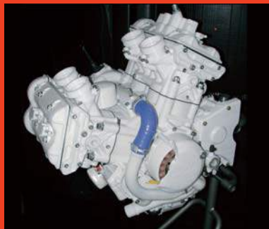
几乎完全由FDM技术打印的PC部件组成的引擎原型
