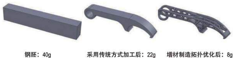
▲ 图 3 CNC 和增材制造生产的开瓶器重量比较
