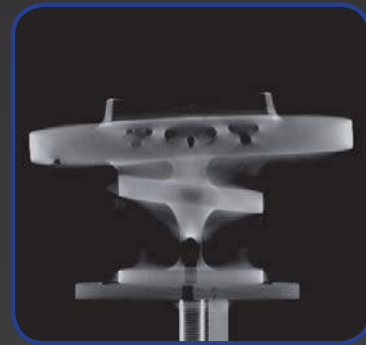
▲ 上图是一张 130 微米分辨率的 X 射线图像，该图像细节表明使用 DMP 技术是制造喷嘴的可行方案
