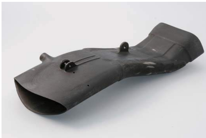
经过测试后的前进气组件（最终版），注意进气导管和前叉接触的区域。
