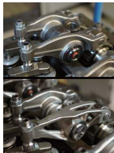
▲ 上：原本的 Euro 6 步进发动机摇臂 下：3D 打印的摇臂
