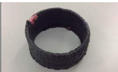
已打印成功的高温合金样件
