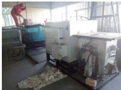
图2 电磁真空增压浇注系统
