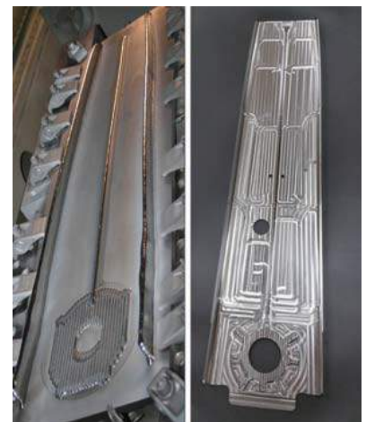
上面这张照片凸显了西亚基 EBAM 工艺在使用钛金属 3D 打印空客飞机尾部上方翼梁时的两个不同阶段。左侧照片呈现了早期预成型阶段的工件。右侧图片呈现了工件的最终形态。
