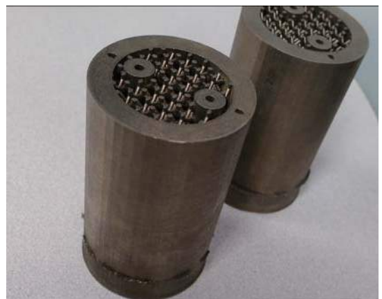
经过热处理后的零件表面光洁度，注意金属的颜色，是热处理过程的结果。
